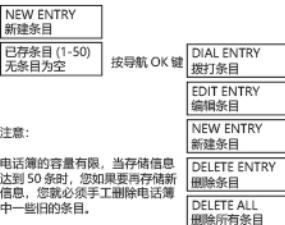
按导航键下键进入菜单, 此时, 液晶屏上显示电话簿第一条目, 如果没有任何条目则显示【NEW ENTRY】。屏幕显示【NEW ENTRY】时, 按导航键OK键后开始:
