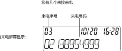
图中03是来电序号(最大50)来电序号表示来电的先后次序。序号01则表示为最新的来电。
